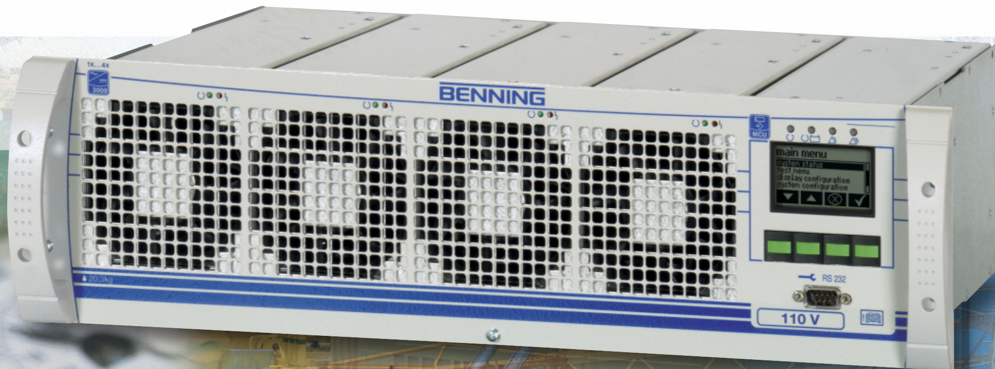
Abb. 7: 19" Gleichrichtereinschub modular mit 4 Modulen TEBECHOP 3000 HDI und Fernüberwachung MCU 2500, Ausgangsspannung 110 V, Ausgangsstrom 80 A
