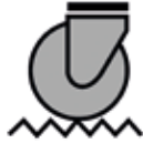
Überlastung durch unebene Böden
