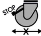
Überlastung durch Bewegungen im festgestellten Zustand
