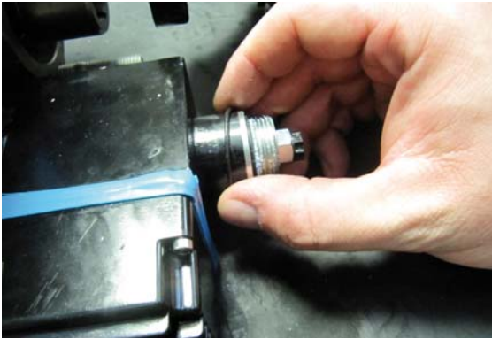
Estrarre la guarnizione OR. Take out O-Ring seal.
