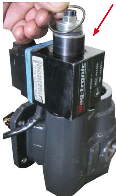
Rimontare la guarnizione OR. Fit again the OR gasket.
