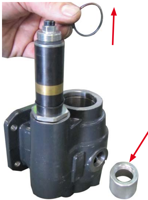
Rimuovere la ghiera e la guarnizione OR indicate. Remove indicated nut and OR gasket.
