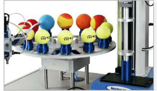
Tennisball-Vorrichtung, auf einem Mecmesin Prüfgerät
