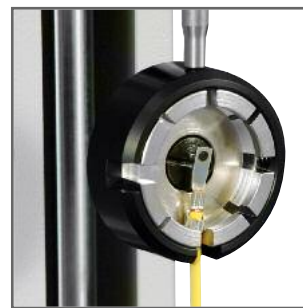
Zugprüfung an Crimpverbindungen
