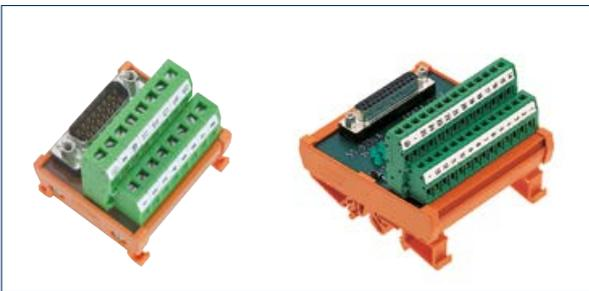
Mit **SD-Modulen** lassen sich Signalleitungen mit Stiftleisten (male) oder Buchsenleisten (female) gemäß IEC 807-2/DIN 41652 auf Schraub- oder Zugfederprintklemmen umsetzen. Die Übergabemodule sind mit den jeweiligen Gegenstücken ausgestattet und in den Polzahlen 9- bis 37-polig lieferbar. Die **SD-LA-Module** verfügen zusätzlich über Statusanzeigen mit Leuchtdioden.
